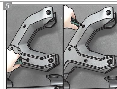
5 Aflojar los tornillos que prenden la cubierta interna de los Conjuntos Cubierta Lateral "O" y "P".
