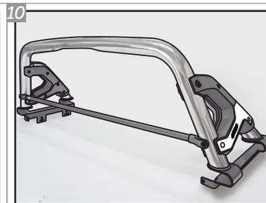
10 Su Barra Antivuelco K3 debe ser como en la imagen de arriba. Colocar el accesorio en el vehículo, ajustar las bases en la caja y dar apriete en las fijaciones previamente aflojadas.
