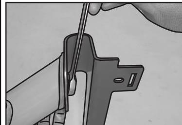
Con la ayuda de un Tornillo "B" y una Arandela "F", fije el Conjunto Cubierta Lateral Derecha "O" a la Base Derecha "M", sin dar el apriete final.
