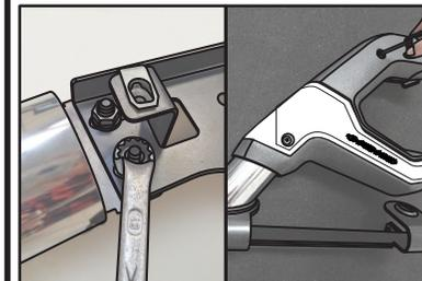
Dé apriete a las dos tuercas, sueltas anteriormente, en la estructura interna de la Cubierta. Después, reposicione las cubiertas de plástico con sus tornillos, sin dar el apriete final. Repita los pasos 1A-5A para el lado izquierdo.
