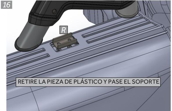
RETIRE LA PIEZA DE PLÁSTICO Y PASE EL SOPORTE
