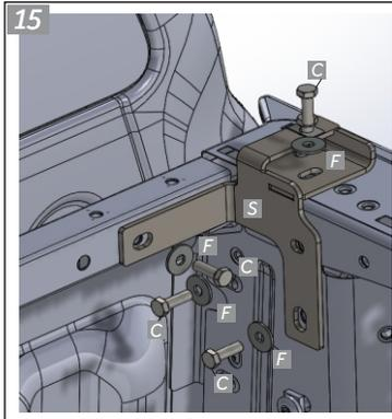
Ensamble el soporte S y T usando para fijar los tornillos C y arandelas F
