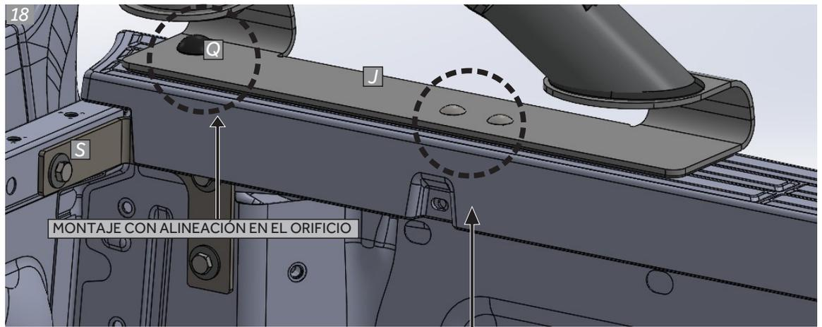
MONTAJE CON ALINEACIÓN EN EL ORIFICIO
