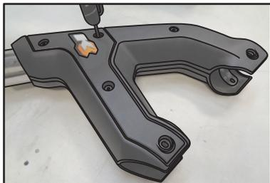
Quite las cubiertas de plástico del Conjunto Cubierta Lateral Derecho "O".
