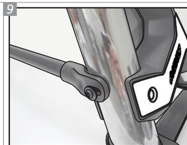
9 Coloque la Barandilla de Vidrio "J", con los extremos en los orificios correspondientes, en el Contorno Delantero, fijando con Tornillos "A" y Arandelas "G".
