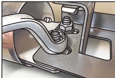
Suelte las dos tuercas, con tornillos franceses, que sujetan la estructura interna al tubo, para que pueda ajustar el tubo con la Base Derecha "M".
