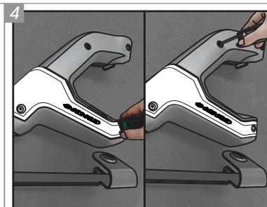
4 Separe el Conjunto Cubierta Lateral Derecha "O". Aflojar los tornillos que prenden la cubierta exterior. Repetir para el Conjunto Cubierta Lateral Izquierda "P".
