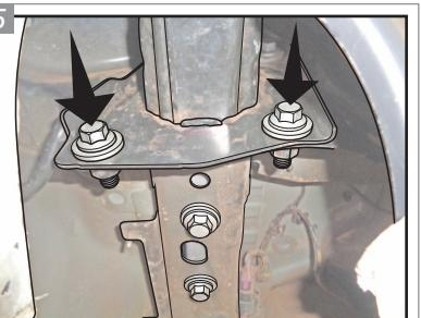
Logo acima das saídas de escapamento, na estrutura do veículo, será possível localizar as duas fixações em destaque. Remova elas temporariamente nos dois lados do veículo.
