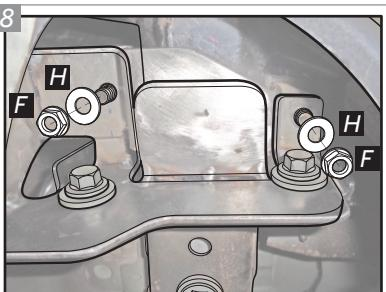
Para terminar a fixação dos suportes, utilize Arruelas "H" e Porcas "F" nos Parafusos "C" que ficaram expostos. Repita os passos 6-8 no outro lado do veículo.
