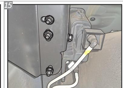
Coloque o Suporte "S" na posição e fixe-o utilizando Porcas "F" e Arruelas "H".
