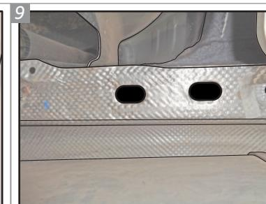
No isolamento térmico do lado esquerdo, faça duas furações coincidentes com os furos presentes na estrutura do veículo.
