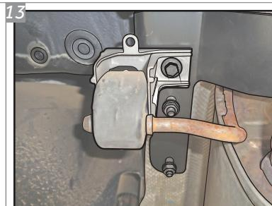
Após fixar o Suporte "S" ao veículo, já é possível fixar novamente o escapamento a estrutura com Parafuso "C" e Arruela "H".
