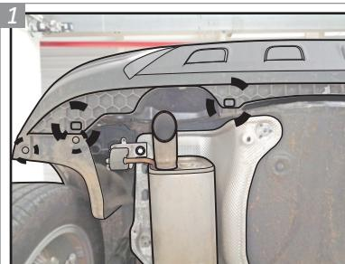
Do lado esquerdo do veículo, solte as fixações na parte de baixo do pára-choque para possibilitar a instalação.
