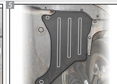
Do lado direito do veículo, solte temporariamente a peça plástica em destaque, para dar acesso as áreas de fixação do suporte.
