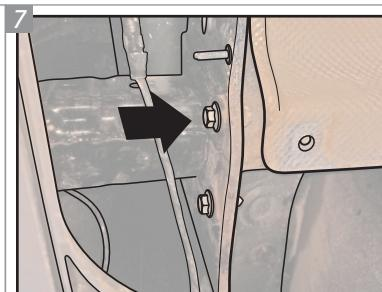
No lado esquerdo do veículo, entre o parachoque e o escapamento, remova o parafuso em destaque.
