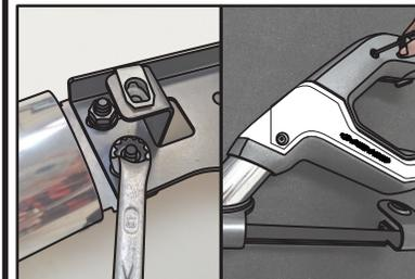
Aperta as duas porcas, previamente liberadas, na estrutura interna da Tampa. Em seguida, reposicione as tampas plásticas com seus parafusos, sem dar o aperto final. Repita os passos 1A-5A para o lado esquerdo.
