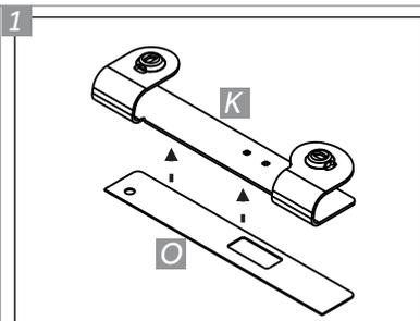
1 Retirar liner das fitas espumas "O", colar na base direita "K" na região de contato com a caçamba. Repita o procedimento para a base esquerda "J".
