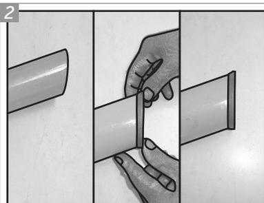
2 Posicione uma Arruela Plástica Traseira "L" na extremidade do Conjunto Capa Lateral Direita "O". Repita para o Conjunto Capa Lateral Esquerda "P".
