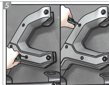
5 Afrouxe os parafusos que fixam a tampa interna dos Conjuntos de Capas Laterais "O" e "P".
