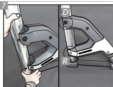
7 Encaixe o Contorno Frontal "Q" nos Conjuntos de Capa Lateral "O" e "P" e fixe-os com o auxílio dos Parafusos "D" na parte superior e inferior, mas utilize os Parafusos "R" na parte inferior da tampa externa.
