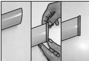
Posicione uma Arruela Plástica Traseira "L" na extremidade do tubo do Conjunto Capa Lateral Direita "O".
