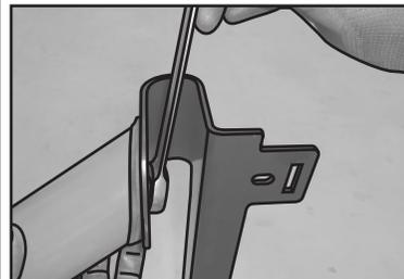
Com o auxílio de um Parafuso "B" e de uma Arruela "F", fixe o Conjunto Capa Lateral Direita "O" na Base Direita "M", sem dar o aperto final.
