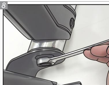
8 Para a fixação do Contorno Dianteiro às bases dos Conjuntos de Capas Laterais, utilize Parafusos "B" e Arruelas "F", sem dar o aperto final.
