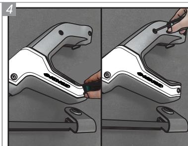
4 Separe o Conjunto Capa Lateral Direita "O". Afrouxe os parafusos que prendem a tampa externa. Repita para o Conjunto Esquerdo "P".
