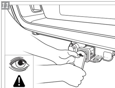
Deslize a ponteira K1 para dentro, de forma que os seus furos e os do engate fiquem alinhados.
