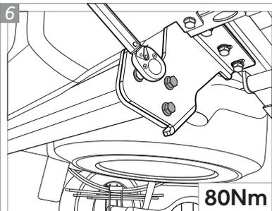
**6** Aperte os três Parafusos "B" do tubo central, com a força indicada na figura. Repita o procedimento no outro lado.
