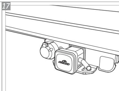
Após colocada, a tampa de proteção deverá ser fixada com o Pino Trava "E" e com o Grampo "D" afim de evitar a perda da mesma.
