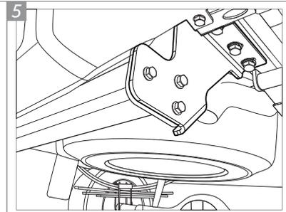
**5** Alinhe as furações da flange do tubo com as furações do Suporte "K" e coloque os Parafusos "B" com as Arruelas "G" e Porcas "F", sem dar aperto. Repita os procedimentos no outro lado do veículo.
