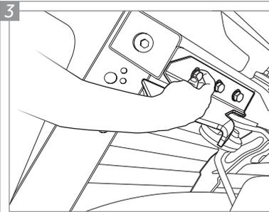
**3** Após, introduza os Parafusos "A" com as Arruelas de Pressão "H" e Arruelas Lisas "G". Repita os procedimentos no outro lado do veículo.
