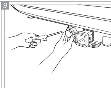
**9** Posicione a Tomada "I" no conjunto estrutura nas furações indicadas e insira os Parafusos "C".
