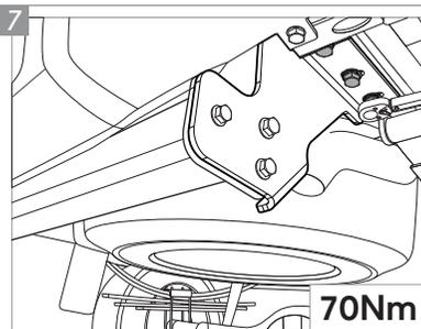
**7** Após, aperte os parafusos do suporte lateral, com a força indicada na figura. Repita o procedimento no outro lado.
