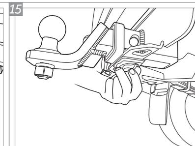
Após posicionar a ponteira K1, localize o o manipulô anti-ruído, na parte inferior do engate. Aperte o mesmo para evitar que a trepidação do veículo, em terrenos irregulares, gere ruídos indesejados.
