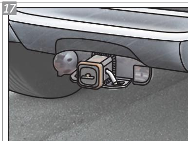
Observe que, quando o engate não for utilizado, a ponteira K1 deve ser substituída pela tampa de proteção.
