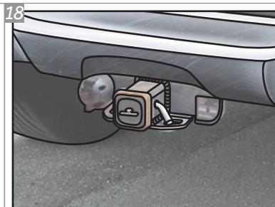
Após colocada, a tampa de proteção deverá ser fixada com o Pino Travá "L" e com o Grampo "K" afim de evitar a perda da mesma.
