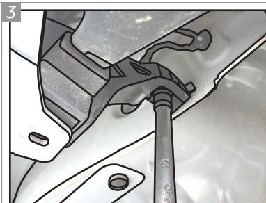
**Para facilitar a passagem do conjunto estrutura, solte as peças plásticas que estruturam a parte interna do parachoque traseiro.**
