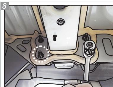
**Retire as duas porcas inferiores do chassi, em cada lado, próximas ao parachoque, e reserve-as.**
