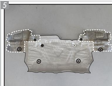
**Com uma chave 8, retire o protetor térmico completamente, corte nas regiões de interferência com os suportes (ilustrado acima) e recoloque-o no veículo.**
