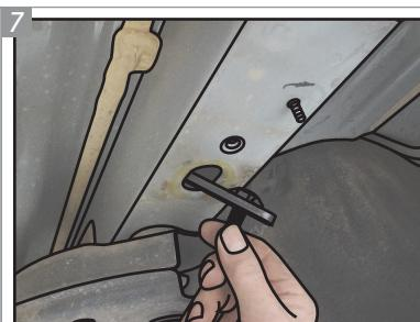
**Passe as Travas Laterais "I" através dos furos, direcionando-as à frente do veículo.**
