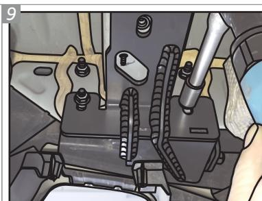
**Posicione os Suportes "M" nos parafusos do veículo e fixe-os com as porcas originais, sem dar aperto final.**
