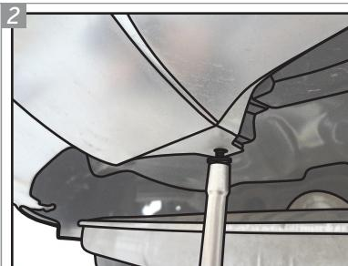
**Retire os dois parafusos da porção inferior do parachoque traseiro.**
