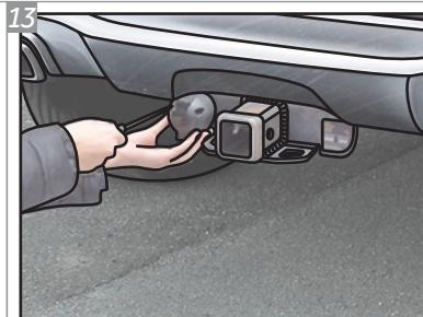
Posicione a Tomada "J" no conjunto estrutura nas furações indicadas e insira os Parafusos "C".
