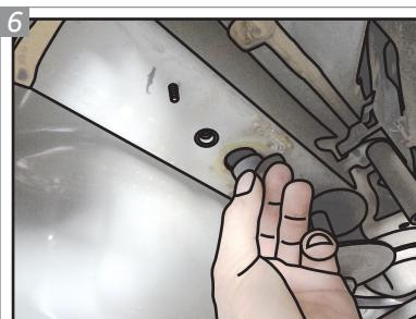
**Retire as duas tampinhas da parte inferior do chassi (uma em cada lado do veículo).**
