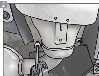
**Com uma chave torx 30, remova as duas ponteiras dos escapamentos, completamente.**
