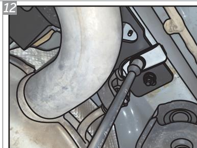
Posicione os suportes dos escapamentos sobre os Suportes "M" e fixe-os com Parafusos "B" e Arruelas "H". Dê aperto final em todas fixações e recoloque todos componentes originais do veículo em suas respectivas posições.
