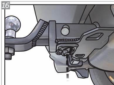
Após posicionar a ponteira K1, localize o manipulo anti-ruído, na parte inferior do engate. Aperte o mesmo para evitar que a trepidação do veículo, em terrenos irregulares, gere ruídos indesejados.
