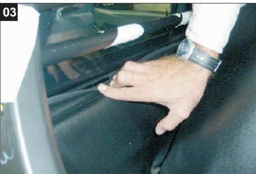
Após fixado o Perfil Frontal, ajustar a Lona sobre o vidro traseiro evitando que ela fique enrugada após a montagem
