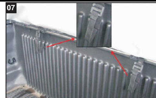
Antes de posicionar a capota marítima sobre a caçamba, prenda as fivelas plásticas nas alças do elástico de fixação do conjunto da capota marítima para evitar o contato da fivela com a caçamba, evitando ruído
