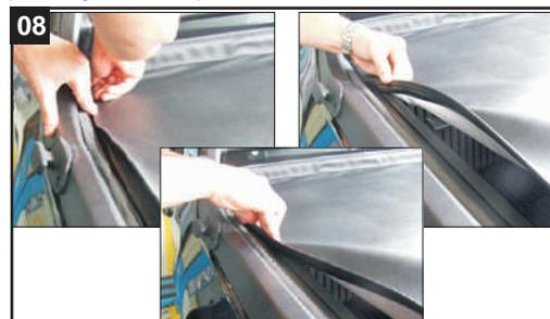
Esticar a Lona encaixando o Perfil Flexível nas extremidades dos Perfis Laterais, Esquerdo e Direito, começando da dianteira para a traseira e em seguida travar a capota marítima na Parte Traseira
