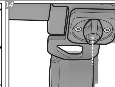
Após posicionar a ponteira K1, localize o manipulo anti-ruido, na parte inferior do engate. Aperte o mesmo para evitar que a trepidação do veículo, em terrenos irregulares, gere ruídos indesejados.
