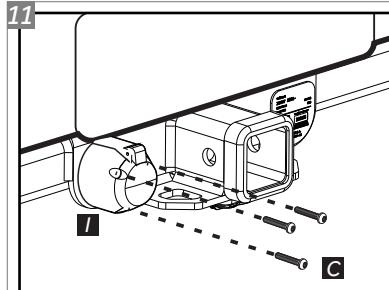
Posicione a Tomada "I" no conjunto estrutura nas furações indicadas e insira os Parafusos "C".
