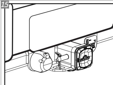
Observe que, quando o engate não for utilizado, a ponteira K1 deve ser substituída pela tampa de proteção. Após colocada, a tampa de proteção deverá ser fixada com o Pino Trava "K" e com o Grampo "J" afim de evitar a perda da mesma.
