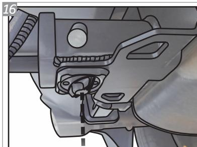
Após posicionar a ponteira K1, localize o o manípulo anti-ruido, na parte inferior do engate. Aperte o mesmo para evitar que a trepidação do veículo, em terrenos irregulares, gere ruídos indesejados.
