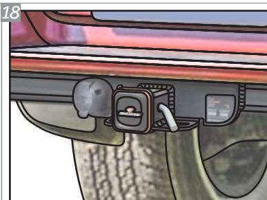
Após colocada, a tampa de proteção deverá ser fixada com o Pino Trava "J" e com o Grampo "I" afim de evitar a perda da mesma.
