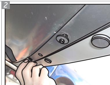
**Retire os 10 parafusos que prendem a peça plástica, na traseira do veículo.**
