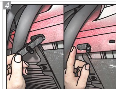
**Passe a Trava Simples "I" pelo furo grande, próximo ao coxim, no lado esquerdo do veículo, deixando o parafuso pra fora.**
