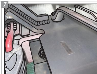
**Com o auxílio de um Parafuso "B" e uma Arruela "F", fixe a porca da Trava Dupla que está dentro do chassi. Repita os passos 2-7 no lado direito do veículo.**
