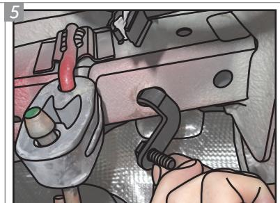
**No outro lado do coxim, se encontra outro furo, passe a Trava Dupla Esquerda "K" por ele, deixando a rosca do parafuso para fora do chassi e, a rosca da porca, alinhada com o furo na lateral.**
