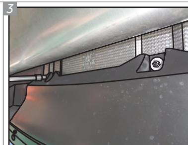
**Remova, também, os dois parafusos que prendem a peça plástica no isolamento térmico. Remova a peça plástica, durante a montagem do acessório.**
