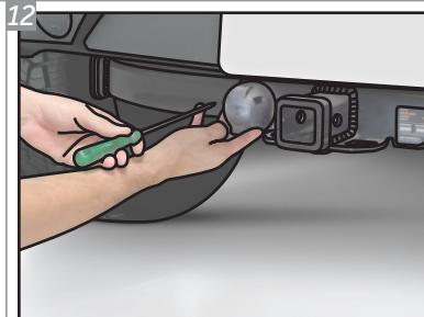
Posicione a Tomada "L" no conjunto estrutura nas furações indicadas e insira os Parafusos "C", com Arruelas "G".
