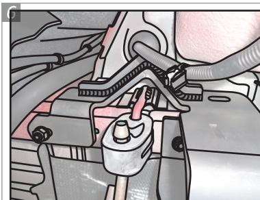
**Posicione o Suporte "O" alinhando com os parafusos no chassi. Para fixar cada trava, coloque uma Arruela "I" com Porca "E" e dê aperto.**
