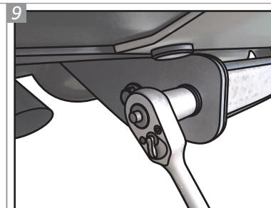
**Posicione o Conjunto Estrutura "P" entre os Suportes e fixe-os, com Parafusos "A", Arruelas "H" e Porcas "D". Dê o aperto final em todas fixações.**
