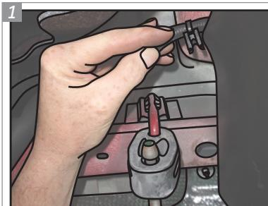
**Na parte inferior traseira esquerda, solte o grampo que prende o chicote do veículo na peça plástica.**
