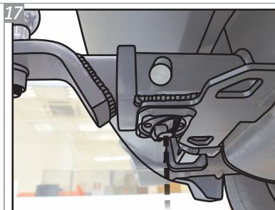
Após posicionar a ponteira K1, localize o manipulo anti-ruido, na parte inferior do engate. Aperte o mesmo para evitar que a trepidação do veículo, em terrenos irregulares, gere ruídos indesejados.
