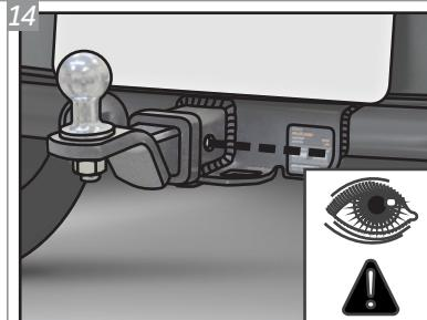
Deslize a ponteira K1 para dentro, de forma que os seus furos e os do engate fiquem alinhados.
