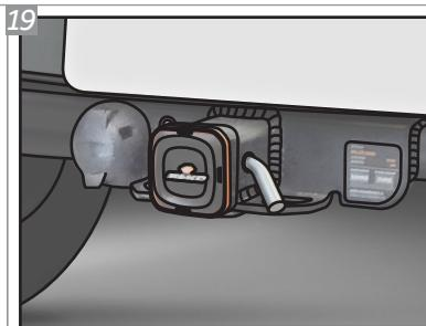
Após colocada, a tampa de proteção deverá ser fixada com o Pino Trava "N" e com o Grampo "M" afim de evitar a perda da mesma.
