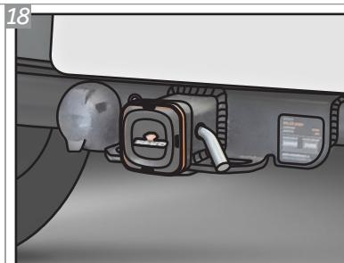
Observe que, quando o engate não for utilizado, a ponteira K1 deve ser substituída pela tampa de proteção.
